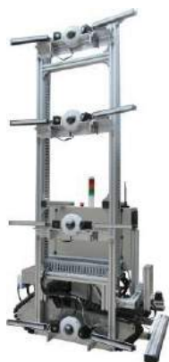
インフラココ 自動走行洞道 点検ロボット
